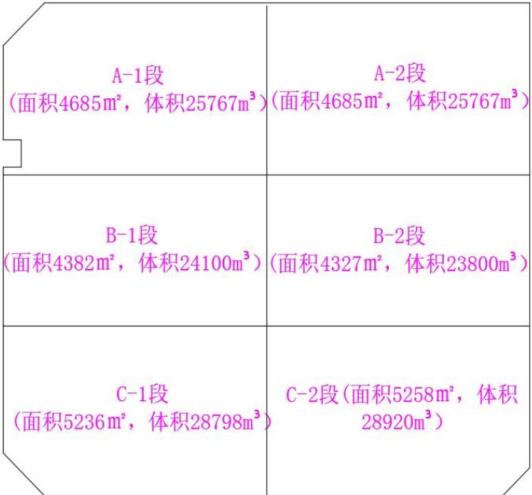
插图 施工流水段划分图
