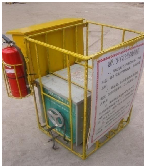
插图 电焊机、灭火器及配电箱工具一体化
