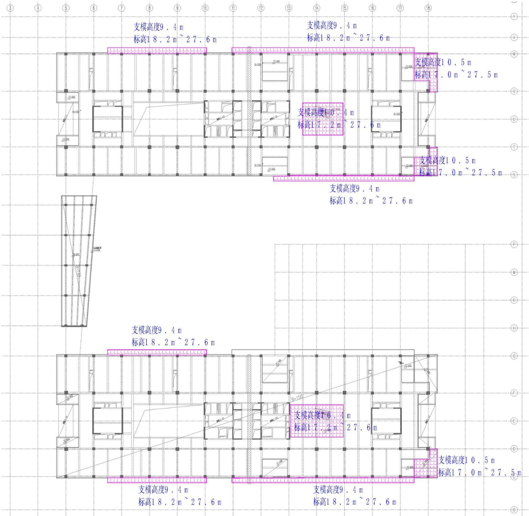
插图 搭设高度 8m 及以上模板分布-6 层结构平面
