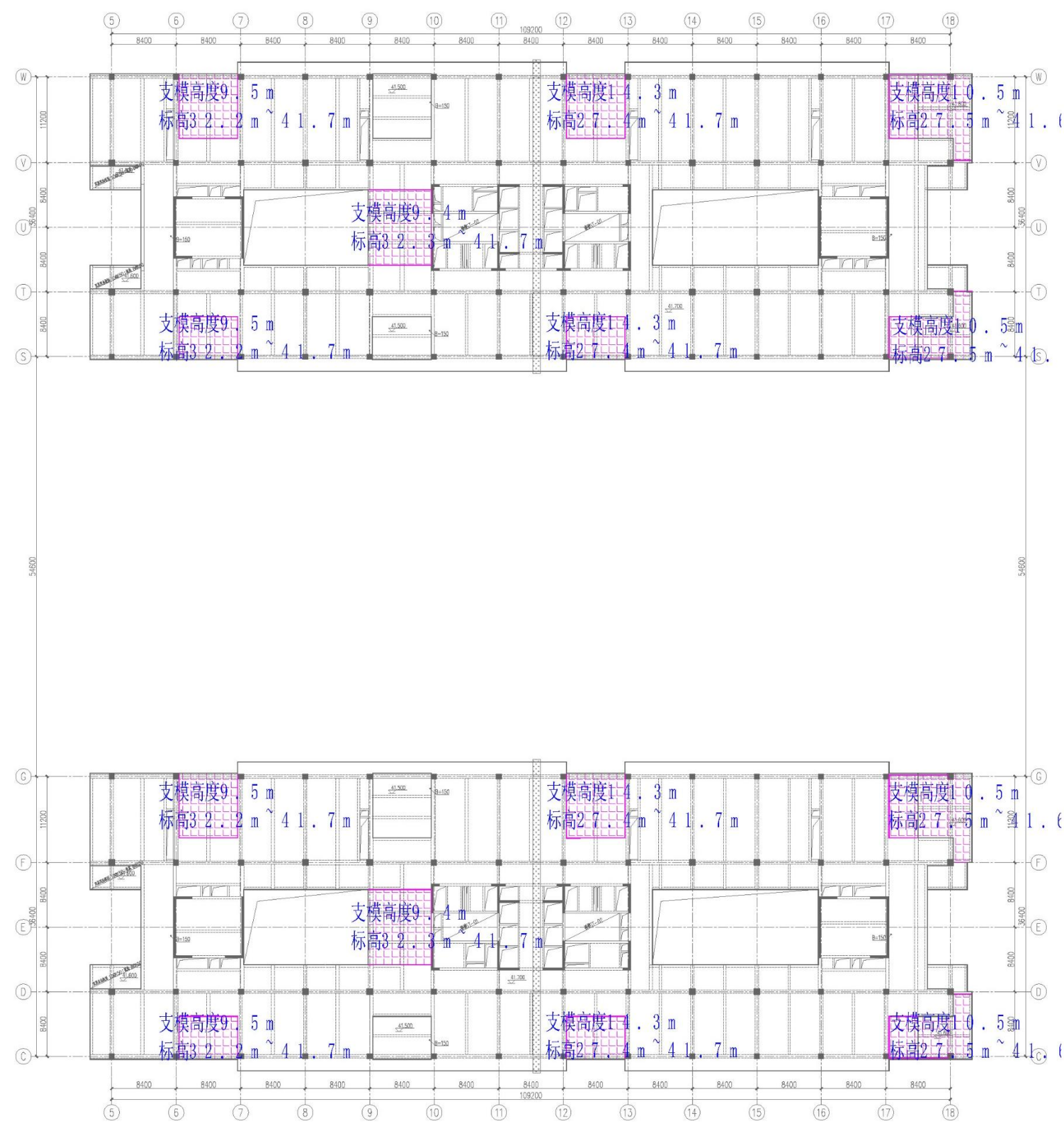
插图 搭设高度 8m 及以上模板分布-9 层结构平面
