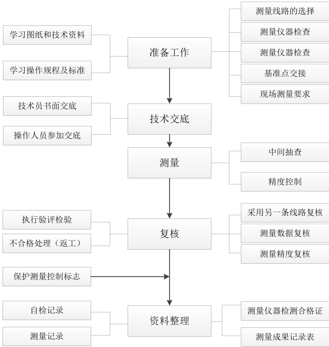
插图 测量工序质量控制流程图
